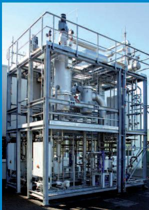
Der Kurzwegverdampfer mit innenliegenden Kondensator von Buss-SMS-Canzler ist der Apparat für anspruchsvolle thermische Trennaufgaben. Durch die Kombination von Verdampfung und Kondensation auf engstem Raum kann der Kurzwegverdampfer mit einem Vakuum von bis zu 0,001 mbar (a) betrieben werden und ist damit hervorragend für die Verdampfung, Konzentration und Entgasung von temperaturempfindlichen, hochsiedenden Produkten geeignet.
